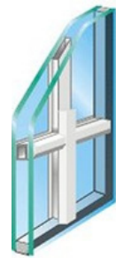
dubbelglas HR++ 4-15-5 tripleglas HR+++ 4-12-4-12-4 glas met ingewerkte roeden
