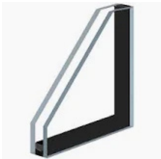
dubbelglas HR++ 4-15-5 tripleglas HR+++ 4-12-4-12-4 glas met ingewerkte roeden
